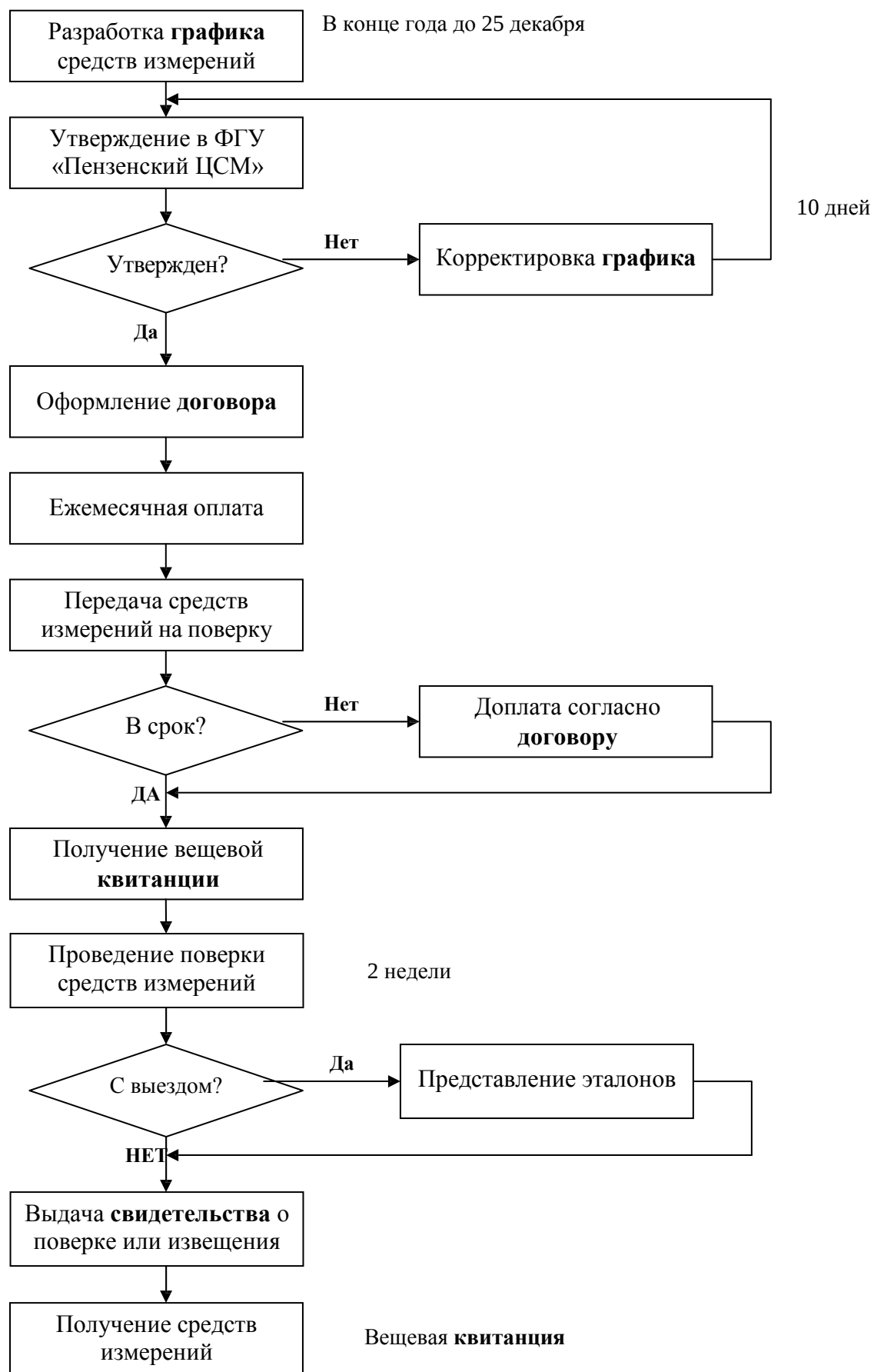
Рисунок 37 – Алгоритм процесса поверки средств измерений
